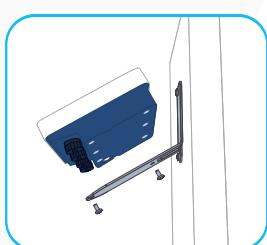
Instalación de Atlas en pared sobre el soporte.
