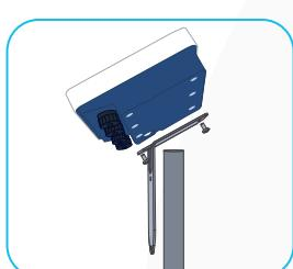
Instalación de Atlas en poste sobre el soporte.
