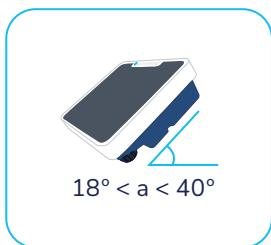
2. Orientar el dispositivo hacia el sol, por ejemplo, hacia el sur con un ángulo de 30° en España.
