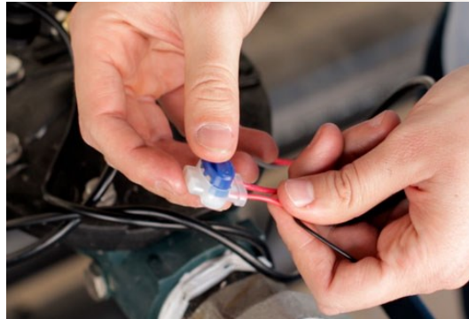
Figura 6. Conexión de la polaridad positiva mediante un conector estanco.
