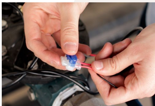
Figura 5. Conexión de la polaridad positiva mediante un conector estanco.
